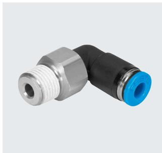
Steckverschraubung mit Schwenkanschluss, 360° rotierend. Das Kugellager ermöglicht rotierende Bewegungen in der Anwendung bis max. 500 U/min. Für Pneumatikanwendungen mit einem Temperaturbereich bis 60 °C und einem Druckbereich bis 14 bar. Schlauch-Außen- $\varnothing$  4, 6, 8, 10 und 12 mm mit Anschlussgewinde M5, R1/8 ... R1/2 und G1/8 ... G1/2.
