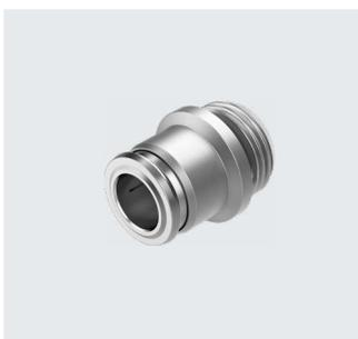
Edelstahlsteckverschraubung. Höchste Korrosionsbeständigkeit KBK4 und Chemikalienresistenz. Für Pneumatikanwendungen mit einem Temperaturbereich bis 150 °C und einem Druckbereich bis 16 bar.
