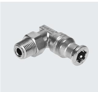
Edelstahlsteckverschraubung. Höchste Korrosionsbeständigkeit KBK4 und Chemikalienresistenz mit Zulassung in der Nahrungsmittel- und Verpackungsindustrie. Für Pneumatikanwendungen mit einem Temperaturbereich bis 120 °C und einem Druckbereich bis 10 bar.
