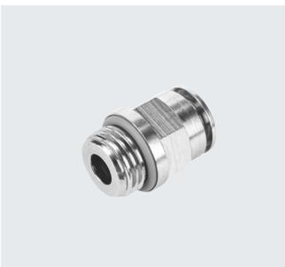
Vollmetallsteckverschraubung aus Messing, chemisch vernickelt. Hohe Korrosionsbeständigkeit KBK3 und Chemikalienresistenz. Für Pneumatikanwendungen mit einem Temperaturbereich bis 150 °C und einem Druckbereich bis 20 bar.
