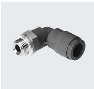
Flammhemmende Steckverschraubung für den Einsatz in allen brandgefährdeten Bereichen, wie zum Beispiel Schweißanlagen in der Automobilindustrie, sowie Gebäudebau. Für Pneumatikanwendungen mit einem Temperaturbereich bis 60 °C und einem Druckbereich bis 10 bar.
