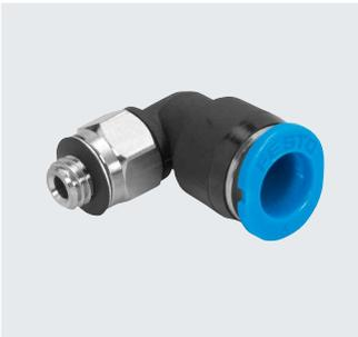
Kleinbauende Steckverschraubung für höchste Packungsdichte auf kleinstem Einbauraum. Für Pneumatikanwendungen mit einem Temperaturbereich bis 80 °C und einem Druckbereich bis 14 bar.
