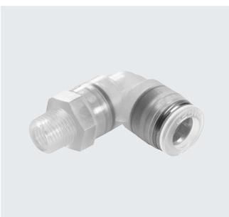
Polypropylenverschraubung für den Einsatz bei Anwendungen mit extremen Medieneinflüssen. Für Pneumatikanwendungen mit einem Temperaturbereich bis 60 °C und einem Druckbereich bis 10 bar.
