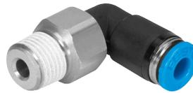
Steckverschraubung mit Schwenkanschluss, 360° rotierend. Das Kugellager ermöglicht rotierende Bewegungen in der Anwendung bis max. 500 U/min. Für Pneumatikanwendungen mit einem Temperaturbereich bis 60 °C und einem Druckbereich bis 14 bar. Schlauch-Außen- $\varnothing$  4, 6, 8, 10 und 12 mm mit Anschlussgewinde M5, R1/8 ... R1/2 und G1/8 ... G1/2.
