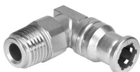
Edelstahlsteckverschraubung. Höchste Korrosionsbeständigkeit KBK4 und Chemikalienresistenz mit Zulassung in der Nahrungsmittel- und Verpackungsindustrie. Für Pneumatikanwendungen mit einem Temperaturbereich bis 120 °C und einem Druckbereich bis 10 bar.
