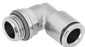
Vollmetallsteckverschraubung aus Messing, chemisch vernickelt. Hohe Korrosionsbeständigkeit KBK3 und Chemikalienresistenz. Für Pneumatikanwendungen mit einem Temperaturbereich bis 150 °C und einem Druckbereich bis 20 bar.
