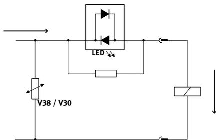
Cada bobina magnética tiene un circuito protector para supresión de arco voltaico y, además, está protegida contra polaridad inversa.
