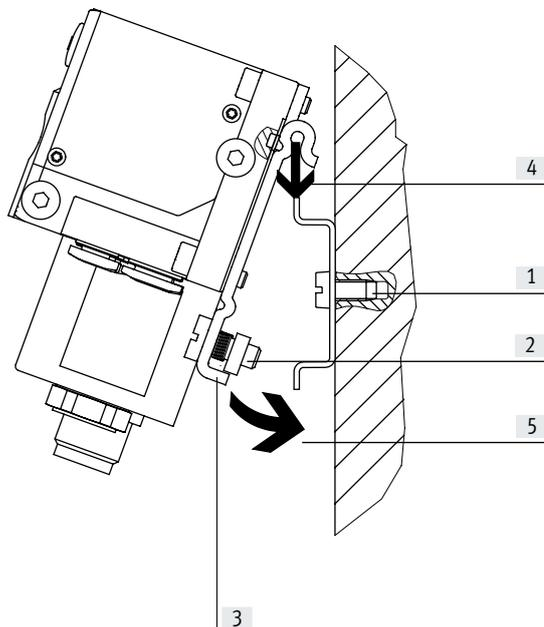
El terminal de válvulas CPV-SC se cuelga en el perfil DIN → flecha [4]. A continuación, el terminal de válvulas se gira hacia el perfil DIN y se fija mediante el elemento de sujeción → flecha [5].
