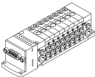
La señal al terminal de válvulas se transmite a través de un cable multifilar preconfeccionado. De esta manera, la instalación resulta mucho más sencilla.
