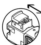
El accionamiento manual auxiliar se mantiene activo hasta que se restablece manualmente (sin herramientas auxiliares).
