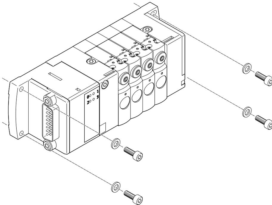
Taladros para el montaje de tornillos M3
