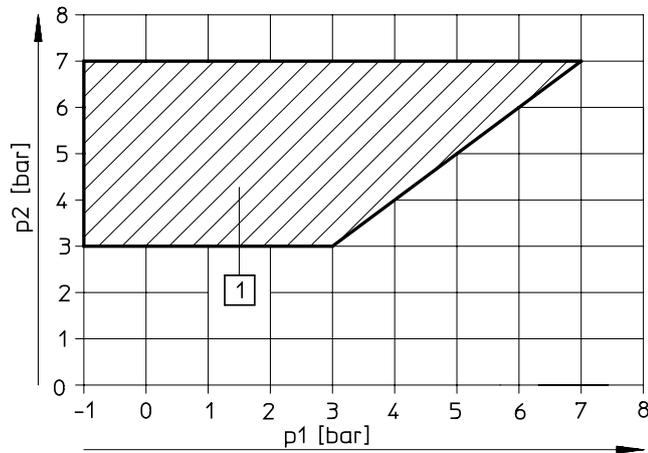
[1] Margen de funcionamiento de válvulas con alimentación del aire de pilotaje, externa
