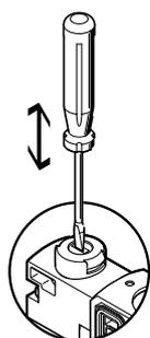
El accionamiento manual auxiliar se acciona presionando con un pasador o un destornillador y vuelve a su posición mediante la fuerza del muelle.
