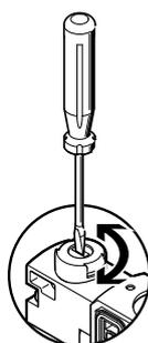
El accionamiento manual auxiliar se mantiene activo hasta que se restablece con un destornillador.
