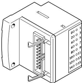
En esta variante de conexión eléctrica, todas las válvulas se controlan de forma centralizada a través del conector de 20 pines.
