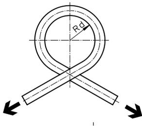
El tubo flexible se dobla en el sentido de su flexión natural hasta que el diámetro exterior del tubo se aplanan un 5 %.
