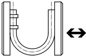
El tubo flexible fijado a la placa básica se dobla hasta que la deformación provoca un pliegue del tubo. El valor medido es el radio de flexión mínimo  $R_{mín}$ .
