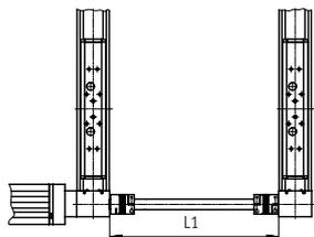
Longitud nominal L1 = separación entre las tapas del accionamiento
