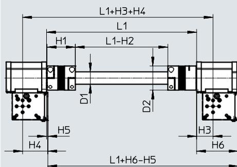
Superficies de montaje del eje giradas hacia fuera
