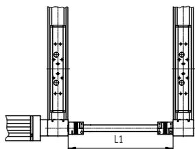
Longitud nominal L1 = separación entre las tapas del accionamiento
