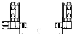
Longitud nominal L1 = separación entre las tapas del accionamiento
