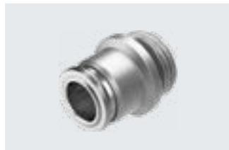
Edelstahlsteckverschraubung. Höchste Korrosionsbeständigkeit KBK4 und Chemikalienresistenz. Für Pneumatikanwendungen mit einem Temperaturbereich bis 150 °C und einem Druckbereich bis 16 bar.
