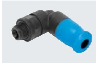
Kunststoffverschraubung für einfache Installation durch Einhandbedienung. Hydrolysebeständig, FDA konform und reinigungsfreundlich. Für Pneumatikanwendungen mit einem Temperaturbereich bis 60 °C und einem Druckbereich bis 10 bar.
