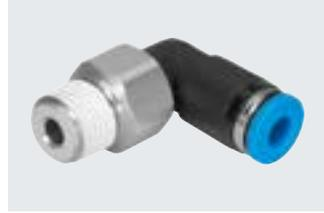
Steckverschraubung mit Schwenkanschluss, 360° rotierend. Das Kugellager ermöglicht rotierende Bewegungen in der Anwendung bis max. 500 U/min. Für Pneumatikanwendungen mit einem Temperaturbereich bis 60 °C und einem Druckbereich bis 14 bar.
