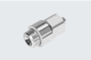
Edelstahlverschraubung für den Einsatz in reinigungsintensiven Bereichen. Höchste Korrosionsbeständigkeit KBK4. Für Pneumatikanwendungen mit einem Temperaturbereich bis 120 °C und einem Druckbereich bis 12 bar.
