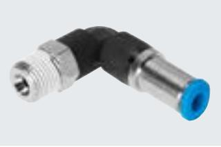
Steckverschraubung sperrt Luftstrom nach dem Lösen des Schlauchs. Für Pneumatikanwendungen mit einem Temperaturbereich bis 60 °C und einem Druckbereich bis 14 bar.
