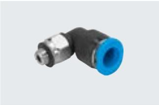
Kleinbauende Steckverschraubung für höchste Packungsdichte auf kleinstem Einbauraum. Für Pneumatikanwendungen mit einem Temperaturbereich bis 80 °C und einem Druckbereich bis 14 bar.
