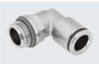
Vollmetallsteckverschraubung aus Messing, chemisch vernickelt. Hohe Korrosionsbeständigkeit KBK3 und Chemikalienresistenz. Für Pneumatikanwendungen mit einem Temperaturbereich bis 150 °C und einem Druckbereich bis 20 bar.
