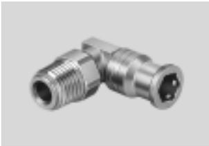
Edelstahlsteckverschraubung. Höchste Korrosionsbeständigkeit KBK4 und Chemikalienresistenz mit Zulassung in der Nahrungsmittel- und Verpackungsindustrie. Für Pneumatikanwendungen mit einem Temperaturbereich bis 120 °C und einem Druckbereich bis 10 bar.
