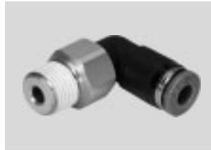
Steckverschraubung mit Schwenkanschluss, 360° rotierend. Das Kugellager ermöglicht rotierende Bewegungen in der Anwendung bis max. 500 U/min. Für Pneumatikanwendungen mit einem Temperaturbereich bis 60 °C und einem Druckbereich bis 14 bar. Schlauch-Außen-Ø 4, 6, 8, 10 und 12 mm mit Anschlussgewinde M5, R $\frac{1}{8}$  ... R $\frac{1}{2}$  und G $\frac{1}{8}$  ... G $\frac{1}{2}$ .
