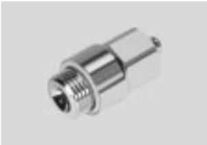
Edelstahlverschraubung für den Einsatz in reinigungsintensiven Bereichen. Höchste Korrosionsbeständigkeit KBK4. Für Pneumatikanwendungen mit einem Temperaturbereich bis 120 °C und einem Druckbereich bis 12 bar. Schlauch-Außen-Ø 4, 6, 8 und 10 mm mit Anschlussgewinde M5 und G $\frac{1}{8}$  ... G $\frac{3}{8}$ .
