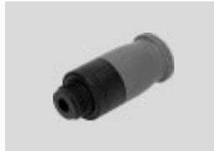
Kunststoffverschraubung für einfache Installation durch Einhandbedienung. Hydrolysebeständig, FDA konform und reinigungsfreundlich. Für Pneumatikanwendungen mit einem Temperaturbereich bis 60 °C und einem Druckbereich bis 10 bar. Schlauch-Außen-Ø 6 mm mit Anschlussgewinde G $\frac{1}{8}$ .
