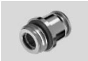
Edelstahlsteckverschraubung. Höchste Korrosionsbeständigkeit KBK4 und Chemikalienresistenz. Für Pneumatikanwendungen mit einem Temperaturbereich bis 150 °C und einem Druckbereich bis 16 bar.
