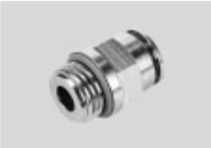
Vollmetallsteckverschraubung aus Messing, chemisch vernickelt. Hohe Korrosionsbeständigkeit KBK3 und Chemikalienresistenz. Für Pneumatikanwendungen mit einem Temperaturbereich bis 150 °C und einem Druckbereich bis 20 bar.
