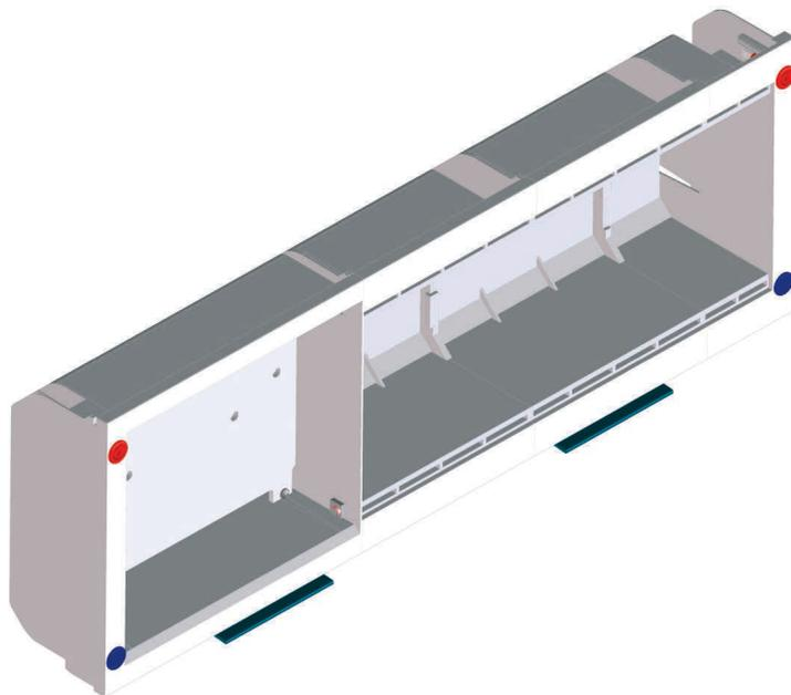
**Taille 3 :** Boîtier terminal ER (à gauche) destiné à recevoir l'automate et doté de différents rails supports, deux extensions centrales ER et un boîtier terminal ER (à droite) destinés à recevoir des modules 19 », d'une largeur de 57 F maximum
