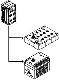
La conexión eléctrica del master CPX CTEL establece la conexión con los módulos con interfaz I-Port (dispositivo) de la familia CTEL/CTEU. Los datos E/S de los dispositivos conectados son transmitidos a los nodos de bus CPX conectados y, de esta manera, a la unidad de control de nivel superior mediante el bus de campo.
