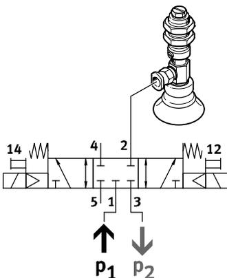
Vakuum, Abwurfimpuls und Ruhestellung mit interner Steuerluft können realisiert werden,
