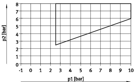
Dieses Diagramm gilt für die 2x 3/2 Ventile und 5/2 monostabilen Ventile mit Luftfeder:
