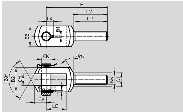
Der Gabelkopf SGA 1 dient in Verbindung mit dem Gelenkkopf SGS 2 (→ Seite 4) zur sphärischen Befestigung von Zylindern.
