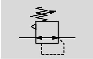
Der Druckregler, ermöglicht das manuelle Einstellen eines bestimmten Druckes in dem geregelten Anschluss vor oder auch nach dem Ventil.
