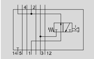
Vertikaldrucksperrplatte, zum Sperren von Kanal 1 und Kanal 14 vor einem Ventil.
