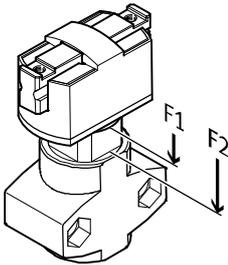
Theoretische Betätigungskraft des Hubausgleichs bei der Ausführungsvariante mit Hubausgleich.
