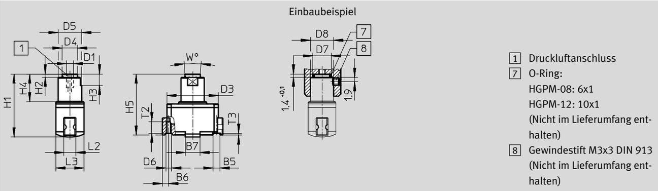
Mit Flanschbefestigung – HGPM-...-E...-G9
