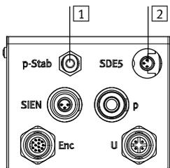
1 Druckluftversorgung für die Stabverlusterkennung. Im Schnittstellengehäuse wird die Druckluft auf 2 bar geregelt.
