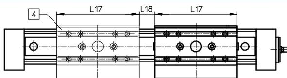
Bei einer Stellachse mit Zusatzschlitten reduziert sich der Arbeitshub um die Länge des Zusatzschlittens und den Abstand zwischen beiden Schlitten.
