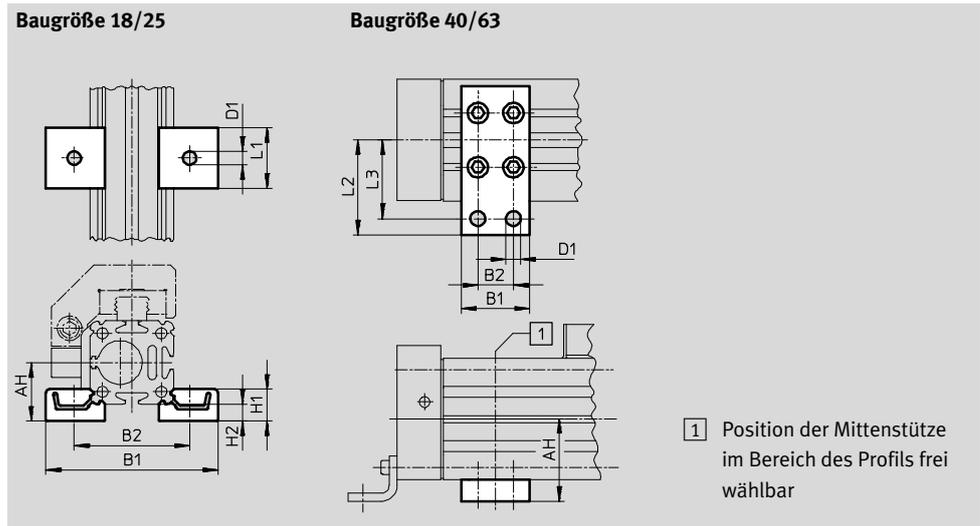
1 Position der Mittenstütze im Bereich des Profils frei wählbar
