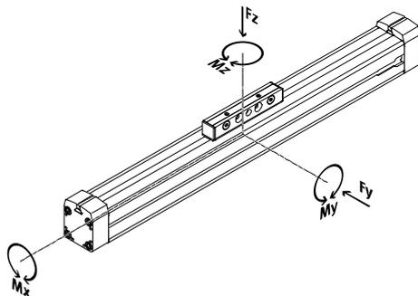
Wirken gleichzeitig mehrere der unten genannten Kräfte auf die Achse ein, müssen neben den aufgeführten Maximalbelastungen folgende Gleichung erfüllt werden:
