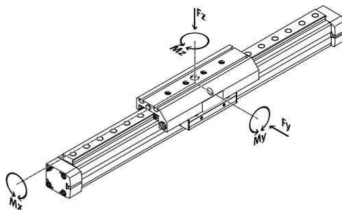
Wirken gleichzeitig mehrere der unten genannten Kräfte und Momente auf die Achse ein, müssen neben den aufgeführten Maximalbelastungen folgende Gleichung erfüllt werden:
