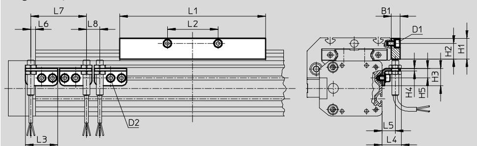
1 Überstand des Sensorkabels, entsprechenden Einbauraum berücksichtigen
