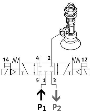
Con aire de pilotaje interno, es posible combinar vacío, impulso de expulsión y posición normal conectando vacío al canal 3 y presión al canal 1 para el impulso de expulsión.
