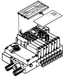
Soporte de placas de identificación ASCF-H-L1-... de las válvulas del terminal VTUG.
