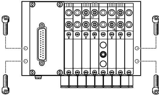
El terminal de válvulas VTUG se fija a la superficie mediante cuatro tornillos M4.
