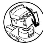
Encajar el accionamiento manual auxiliar con bloqueo sobre la válvula servopilotada. Posteriormente, se puede accionar la tapa del accionamiento manual auxiliar con enclavamiento sin herramienta.
