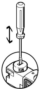
El accionamiento manual auxiliar se acciona presionando con un pasador o con un destornillador y regresa a su posición mediante reposición por muelle (la posición bloqueada se evita mediante la tapa ciega codificada).
