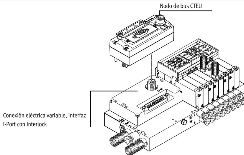
Conexión eléctrica variable, interfaz I-Port con Interlock
