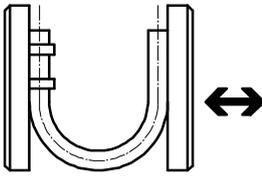
El tubo flexible sujeto a la placa base se dobla hasta que la deformación provoca el quebrado del tubo. El valor medido es el radio de flexión mínimo Rmín. Este Rmín tiene como consecuencia una reducción considerable del caudal.
