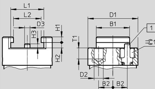
Para realizar la fijación, el adaptador de clips necesita un agujero para colocar el pasador de sujeción (medida D3). Para realizar el montaje, presionar el adaptador de clips contra el pasador de sujeción de la pieza de presión. A continuación, introducir el adaptador de clips en la ranura en T de la interfaz hasta que el pasador de sujeción encaje en el agujero.
