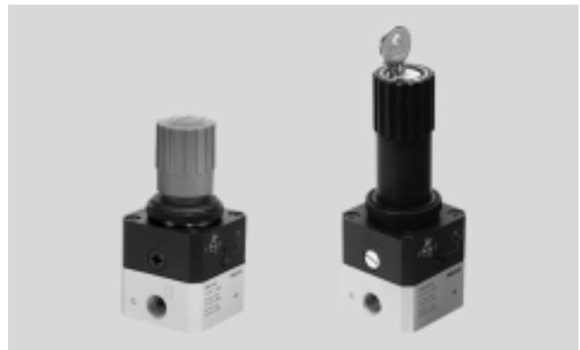
Das Präzisions-Druckregelventil regelt den Betriebsdruck (Sekundär-Seite) über eine Membranvorsteuerung, die auf den Hauptsitz einwirkt und dadurch eine bessere Regelcharakteristik erreicht.
