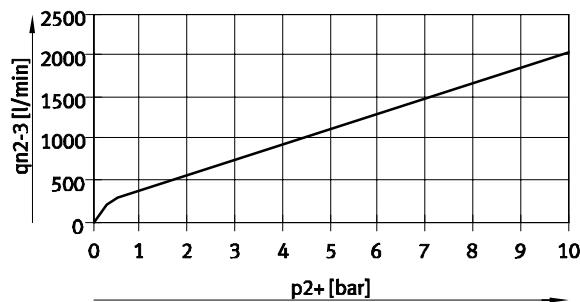
průtok qn 1 → 2 v závislosti na výstupním tlaku p2
