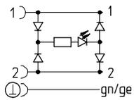
24 V DC 的型号具有极性容错保护, 以及保护电路, 可用于峰值电压最高 100 V DC, 而且集成了状态时显示的黄色 LED (KMEB-...: 没有端口 gn/ge)。
