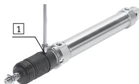
波纹管组件是一种无泄漏系统。为防止吸入异物, 必须通过连接件 [1] 上的压力补偿孔进气和排气。
