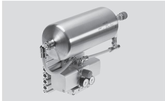
增压阀和不锈钢结构贮气罐的组合绕开了单向阀, 通过系统压力给贮气罐持续注气, 配有压力表
