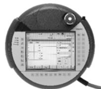
示教盒CDSA具有紧急停机开关及一个3段式使能钥匙。两个设备都设计有两个通道，即可集成到客户的安全电路中。使能键的作用是在设置中核准驱动功率。除了硬件和符合人体工程学的把手，CDSA还有一块彩色触摸屏，可替代键盘来操作。
