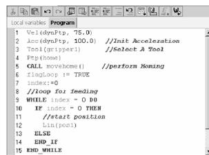
义运动程序用纯文本型宏编程工具 Festo 示教语言(FTL)编程。这个强大的编程工具包括了各种动作的宏、动态设置以及外围设备（例如，抓手）的I/O处理。该编程工
