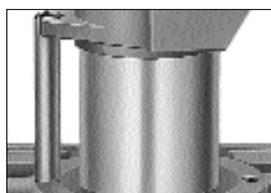
Com o rolete travado o magazine de transporte não pode ser empurrado de volta pelo amortecedor
