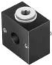
O distribuidor é instalado entre a unidade de filtro regulador (LFR) e o lubrificador (LOE). Utilizando-se uma conexão G $\frac{1}{4}$  na saída adicional, pode-se desviar o ar filtrado não lubrificado para a alimentação de barreiras de ar comprimido de alta pureza conectando-se a um filtro coalescente Tipo LFMA
