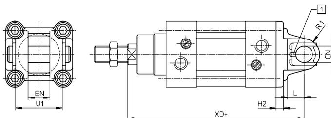
1 O pino-eixo está protegido contra rotação através de um pino de fixação.
