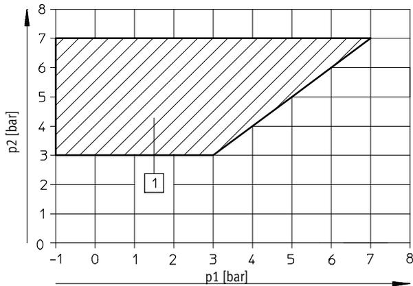
1 Margen de funcionamiento de válvulas con aire de pilotaje externo
