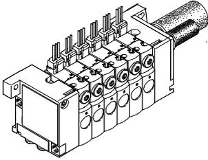
Conexión posible independientemente del control y con conexión flexible mediante cables preconfeccionados. De esta manera, la conexión tiene polos inconfundibles.
