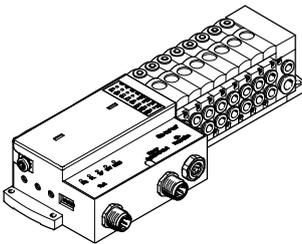
La transmisión de datos a un PLC está a cargo de un nodo de bus de campo. De esta manera, es posible obtener una solución de dimensiones compactas en su parte neumática y electrónica.
