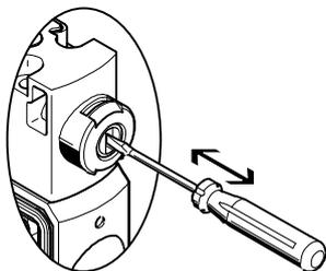
El accionamiento manual auxiliar se manipula presionando con un pasador o un destornillador y vuelve a su posición mediante la fuerza elástica del muelle.
