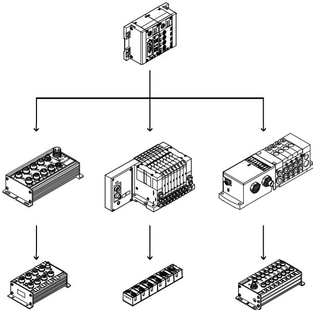
Terminal de válvulas para sistema de instalación CPI.
