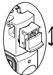
El accionamiento manual auxiliar se mantiene activo hasta que se restablece manualmente (sin herramientas auxiliares).
