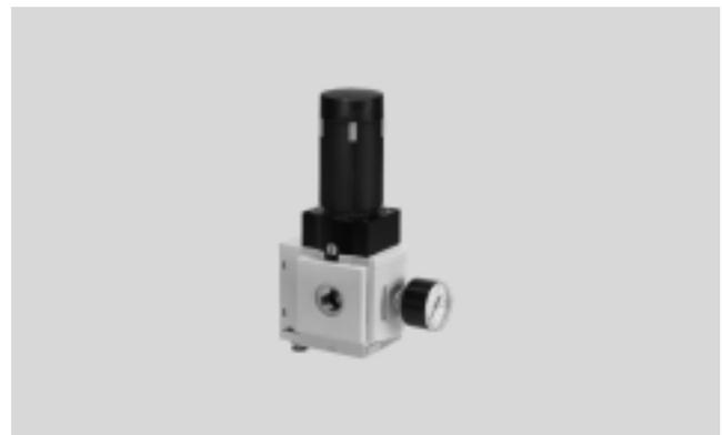
de regulación es posible regular la presión de salida p2 manualmente con el botón giratorio o neumáticamente mediante una presión de pilotaje p12 con regulador externo (de ser posible, con una válvula reguladora de precisión). Al desconectar la presión de entrada p1, se descarga la presión de salida p2 a través de la conexión 3 (escape secundario).
