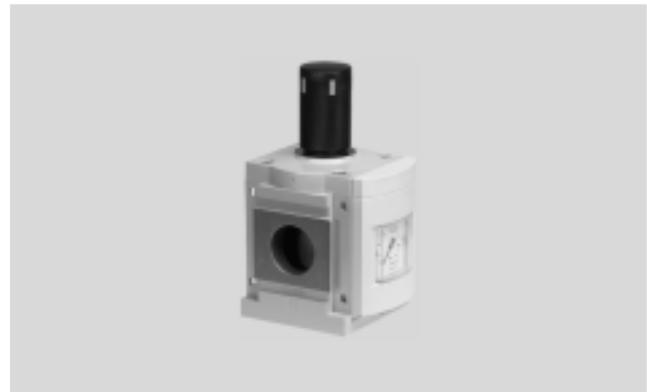
Este regulador mantiene constante la presión de salida p2 independientemente de las oscilaciones de la presión y del consumo de aire. Dentro del margen de regulación es posible regular la presión de salida p2 manualmente con el botón giratorio o neumáticamente mediante una presión de pilotaje p12 con regulador
