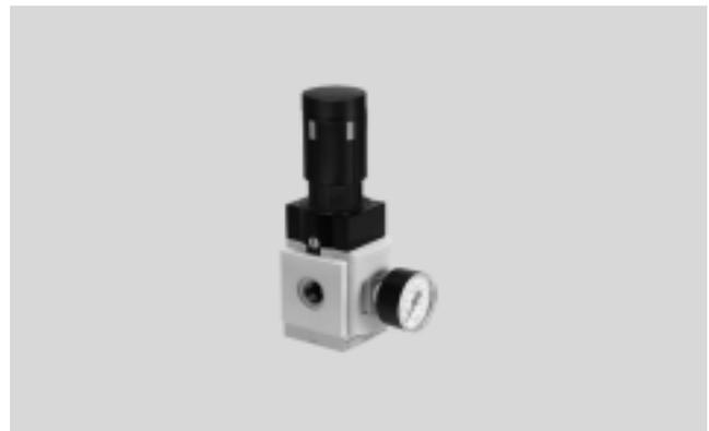
La válvula de precisión, reguladora de presión, es apropiada para aplicaciones que exigen una histéresis de presión de 0,02 bar. Dentro del margen de regulación es posible regular la presión de salida p2 manualmente con el botón giratorio o neumática-
