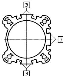
Mediante la selección de la característica D3 en el producto modular, puede detectarse la posición del émbolo en 3 lados del accionamiento.
