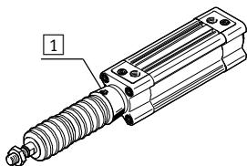
El conjunto de fuentes no tiene fugas. Con el fin de evitar la aspiración de fluidos no apropiados, la pieza de conexión **1** tiene un taladro para alimentación y descarga común del aire.
