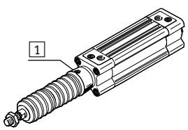
El conjunto de fuelles es un sistema exento de fugas. El aire de alimentación y descarga del conjunto es común a través de un taladro de compensación de presión **1**, para evitar la
