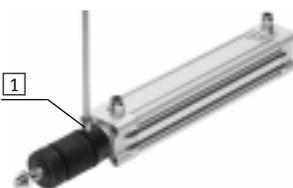
El conjunto de fuelles es un sistema exento de fugas. El aire de alimentación y descarga del conjunto es común a través de un taladro de compensación de presión **1**, para evitar la aspiración de fluidos no deseados. Esta solución protege el vástago, la junta y la culata frente a fluidos
