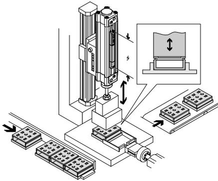
Der SDAT-MHS ist ein Positionstransmitter der im Erfassungsbereich die Kolbenbewegung kontinuierlich erfasst und als wegproportionales Ausgangssignal zur Verfügung stellt.
