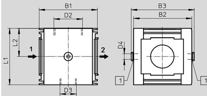
1) G $\frac{1}{4}$  Innengewinde im Gehäuse, standardmäßig mit Verschlusschraube verschlossen
