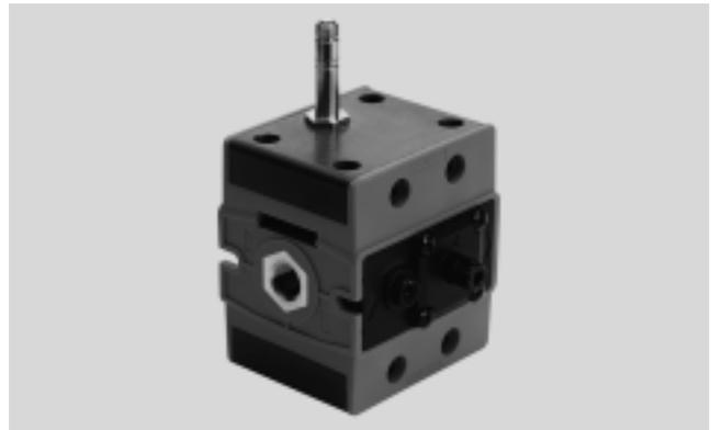
Elektrisch betätigtes Einschaltventil für langsamen Druckaufbau in pneumatischen Anlagen. Damit wird der Anlauf von pneumatischen Anlagen abgesichert. Über ein einstellbares Drosselventil strömt eine geringe Luftmenge in die Anlage. Der Ausgangsdruck wird langsam aufgebaut. Nachgeschaltete Zylinder und Arbeitsgeräte gehen langsam
