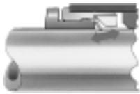
Über die rostfreie Stahlkralle wird der Schlauch ohne Beschädigung der Oberfläche gehalten. Schwingungen und Druckstöße werden absorbiert.
