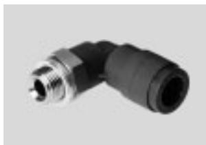
Flammhemmende Steckverschraubung für den Einsatz in allen brandgefährdeten Bereichen, wie zum Beispiel Schweißanlagen in der Automobilindustrie, sowie Gebäudebau. Für Pneumatikanwendungen mit einem Temperaturbereich bis 60 °C und einem Druckbereich bis 10 bar.
