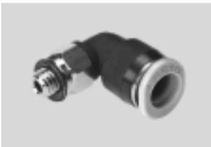
Kleinbauende Steckverschraubung für höchste Packungsdichte auf kleinstem Einbauraum. Für Kernfunktionen in der Pneumatik mit einem Temperaturbereich bis 60 °C und einem Druckbereich bis 10 bar.
