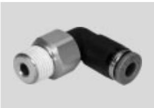
Steckverschraubung mit Schwenkanschluss, 360° rotierend. Das Kugellager ermöglicht rotierende Bewegungen in der Anwendung bis max. 500 U/min. Für Pneumatikanwendungen mit einem Temperaturbereich bis 60 °C und einem Druckbereich bis 14 bar.
