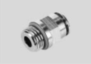
Vollmetallsteckverschraubung aus Messing, chemisch vernickelt. Hohe Korrosionsbeständigkeit KBK3 und Chemikalienresistenz mit Zulassung in der Nahrungsmittel- und Verpackungsindustrie. Für Pneumatikanwendungen mit einem Temperaturbereich bis 150 °C und einem Druckbereich bis 20 bar.
