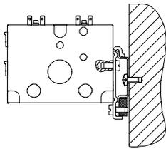
Para terminal de válvulas CPV10/14 CPV10/14-VI-BG-NRH-35 (código H)
