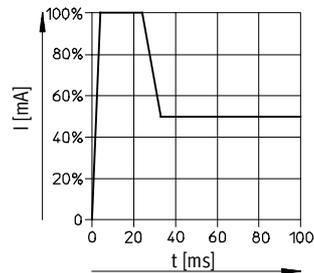
Las válvulas CPV10/14 se activan con reducción de corriente para ahorrar energía y disminuir el calor. Esta reducción de la corriente está integrada en la unidad eléctrica básica (multipolo o conexión de bus de campo) o en el cable de conexión. Al desconectar, los picos de tensión se limitan a 38 V DC.
