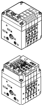
El AS-Interface se distingue por permitir la transmisión simultánea de datos y energía a través de un cable bifilar. La forma codificada del cable impide confundir los polos. Si es necesario cortar la tensión de las válvulas en casos de emergencia, las válvulas pueden ser alimentadas por separado a través de otra conexión. Existen dos versiones de terminales de válvulas para funcionamiento A/B.
