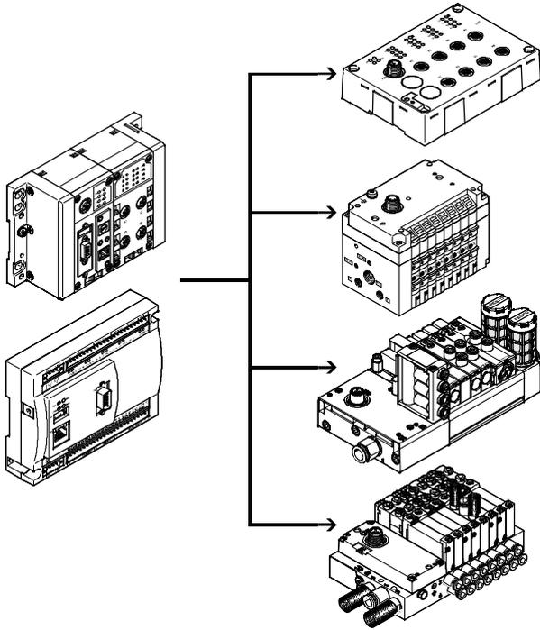
Un sistema CTEL está compuesto del master CTEL y de las unidades con interfaz I-Port, conectadas entre sí mediante cables especiales. De este modo es posible obtener una configuración descentralizada. Los terminales de válvulas y módulos E/S con interfaz I-Port pueden montarse muy cerca a los cilindros a controlar. De esta manera, los tubos neumáticos pueden ser más cortos, lo que reduce los tiempos necesarios para la alimentación y el escape del aire.
