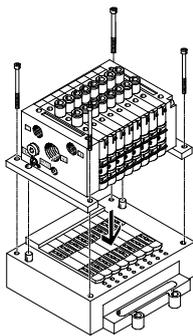
Para terminal de válvulas CPV10/14 CPV...-VI-BG-ET200X (elemento de fijación, código X)
