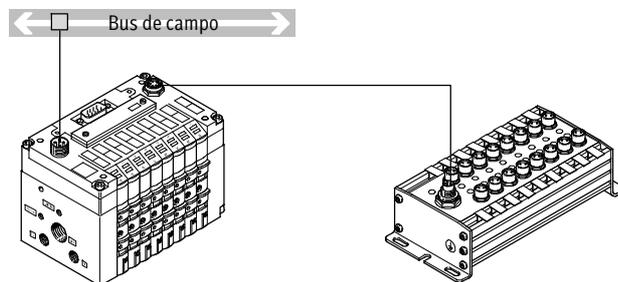
El bus de campo Direct es un sistema compacto para la conexión de un terminal de válvulas CPV, CPV-SC, CPA-SC o CDVI a diversos estándares de bus de campo, como por ejemplo PROFIBUS y DeviceNet.
