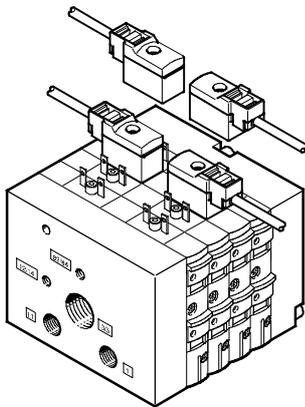
En el caso de conexión individual, sólo está integrada la parte neumática. Las electroválvulas se conectan individualmente por separado.
