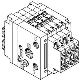
Con la ampliación de las válvulas (concatenación vertical) es posible agregar funciones neumáticas adicionales al terminal de válvulas CPV de tamaños 10 y 14.
