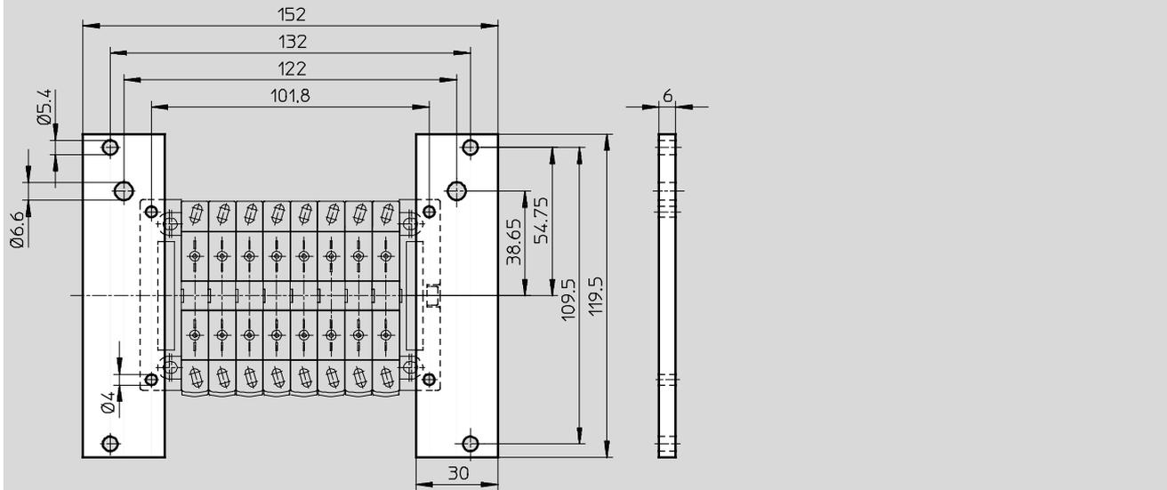
Fijación CPV14-VI-BG-ET200X para conexión individual y ET200X
