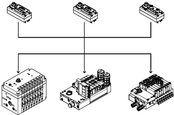
CTEU es un sistema que ocupa poco espacio, apropiado para conectar un terminal de válvulas a diversos estándares de bus de campo (por ejemplo, Profibus y DeviceNet). El nodo de bus de campo se monta directamente sobre la interfaz I-Port del terminal de válvulas.
