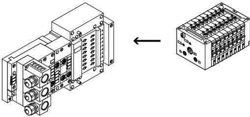
Adaptación del terminal de válvulas al módulo de entradas y salidas ET200X/ET200pro de Siemens: Combinando los módulos funcionales de la unidad ET200X/ET200pro con las funciones neumáticas del terminal de válvulas CPV se obtiene una solución de automatización altamente integrada para sistemas con actuadores eléctricos y neumáticos con:
