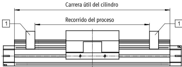
1 Topes fijos para montar el actuador o montaje externo
