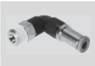
El racor bloquea el flujo de aire al soltar el tubo flexible. Para aplicaciones neumáticas con temperaturas de hasta 60 °C y con presiones de hasta 14 bar. Diámetros exteriores de los tubos flexibles de 4, 6, 8, 10 y 12 mm con rosca de conexión M5, R $\frac{1}{8}$  ... R $\frac{1}{2}$  y G $\frac{1}{8}$  ... G $\frac{1}{2}$ .
