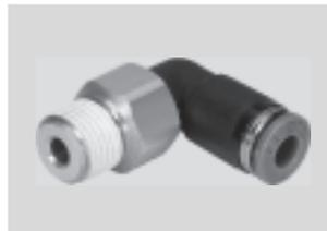
Racor rápido roscado con conexión orientable en 360°. Rodamiento de bolas para movimientos giratorios de hasta 500 rpm. Para aplicaciones neumáticas con temperaturas de hasta 60 °C y con presiones de hasta 14 bar. Diámetros exteriores de los tubos flexibles de 4, 6, 8, 10 y 12 mm con rosca de conexión M5, R $\frac{1}{8}$  ... R $\frac{1}{2}$  y G $\frac{1}{8}$  ... G $\frac{1}{2}$ .
