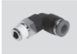
Gran selección de racores rápidos roscados para aplicaciones neumáticas con temperaturas de hasta 80 °C y con presiones de hasta 14 bar. Diámetros exteriores de los tubos flexibles de 4, 6, 8, 10, 12 y 16 mm con rosca de conexión de R1/8 ... R1/2 y G1/8 ... G1/2.
