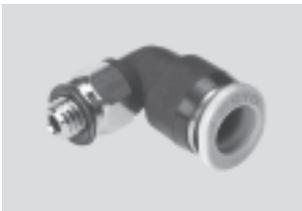
Racor rápido roscado de pequeñas dimensiones para lograr el más alto grado de integración en espacios reducidos. Para aplicaciones neumáticas básicas con temperaturas de hasta 60 °C y con presiones de hasta 10 bar. Diámetros exteriores del tubo flexible de 3, 4 y 6 mm con rosca de conexión M3, M5, M7 y R1/8.
