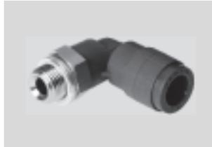
Racor rápido roscado pirorretardante para la utilización en zonas con peligro de incendio, por ejemplo en equipos de soldadura en la industria automovilística o en el sector de la construcción. Para aplicaciones neumáticas con temperaturas de hasta 60 °C y con presiones de hasta 10 bar. Diámetros exteriores de los tubos flexibles de 4, 6, 8, 10 y 12 mm con rosca de conexión R1/8 ... R1/2 y G1/8 ... G1/2.
