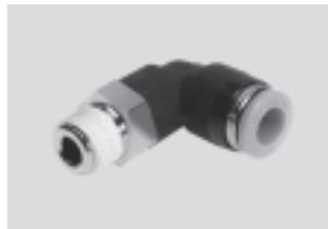
Racores rápidos roscados para funciones neumáticas básicas con temperaturas de hasta 60 °C y con presiones de hasta 10 bar. Diámetros exteriores de los tubos flexibles de 4, 6, 8, 10, 12 y 16 mm con rosca de conexión de M5 y R1/8 ... R1/2.
