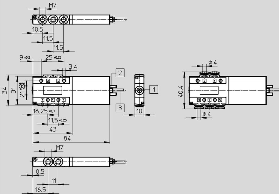
1 Accionamiento manual auxiliar mediante pulsador
