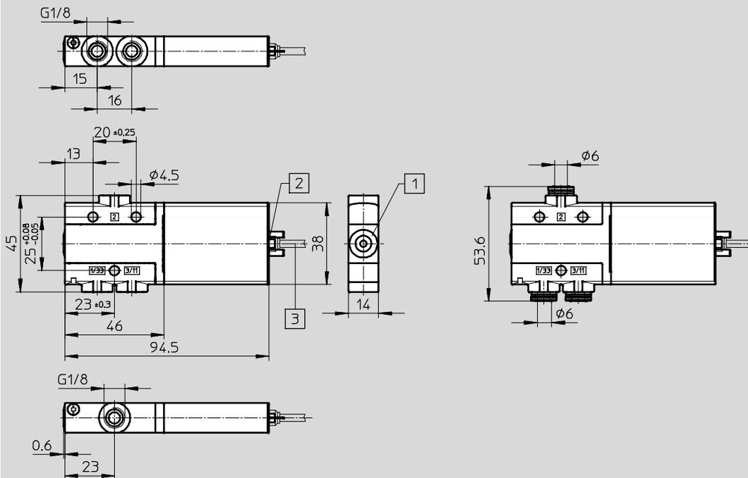
1 Accionamiento manual auxiliar mediante pulsador
