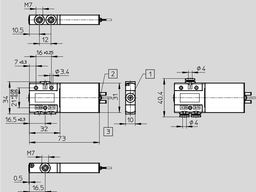
1 Accionamiento manual auxiliar mediante pulsador
