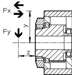
$$\frac{F_{y(z)}}{F_{y,max(z)}} + \frac{F_{x,comp.(v)}}{F_{x,comp.,max.(v)}} + \frac{F_{x,trac.(v)}}{F_{x,trac.,max.(v)}} \leq 1$$
