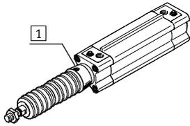
El conjunto de fuelles no tiene fugas. Con el fin de evitar la aspiración de fluidos no apropiados, la pieza de conexión 1 tiene un taladro para alimentación y descarga común del aire.
