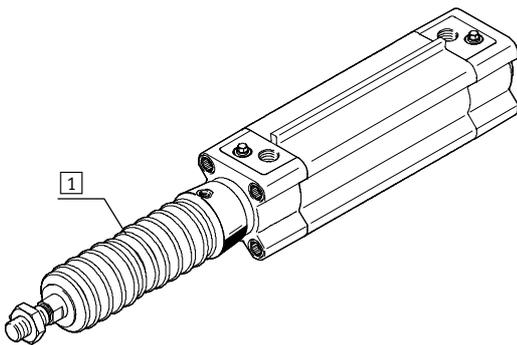
El conjunto de fuelles es un sistema exento de fugas. El aire de alimentación y descarga del conjunto es común a través de un taladro de compensación de presión situado en el componente de unión **1**, para evitar la aspiración de fluidos no deseados. Esta solución protege al vástago, a la
