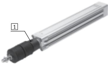
El conjunto de fuelles es un sistema exento de fugas. El aire de alimentación y descarga del conjunto es común a través de un taladro de compensación de presión (1), para evitar la aspiración de fluidos no deseados. Esta solución protege el vástago, la junta y la culata frente a fluidos
