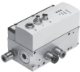
La válvula posicionadora de 5/3 vías para aplicaciones con Soft Stop y tareas de posicionamiento neumático. Plenamente digitalizada: con sensores de presión integrados, con nuevas funciones de diagnóstico. Disponible en tamaños 4, 6, 8 y 10. Caudales de 350, 700, 1 400 y 2 000 l/min.
