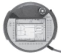
La unidad de mando CDSA tiene un interruptor de parada de emergencia y tres teclas de afirmación en tres niveles. Ambas unidades tienen dos canales y están preparadas para su integración en los circuitos de seguridad instalados por el cliente. Las teclas de afirmación se utilizan para confirmar las operaciones de ajuste durante la puesta en funcionamiento. Además de tratarse de una unidad ergonómica, la CDSA tiene, además de las teclas, una pantalla táctil de color que permite ejecutar comandos.
