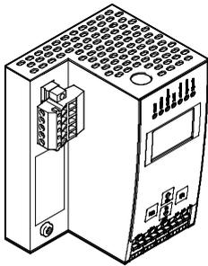
Los gateway AS-Interface CESA se usan para conectar la red AS-Interface a un bus de campo superior. Hacen las veces de master en la red AS-Interface y de slave en la red de bus de campo.
