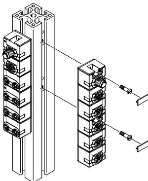
Con tuercas deslizantes para M4; por lo demás, montaje en la pared.
