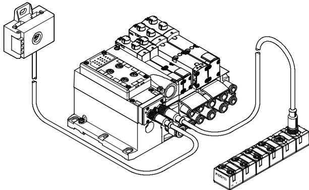
Los terminales de válvulas VTSA/VTSA-F pueden ampliarse con los compactos módulos E/S.
