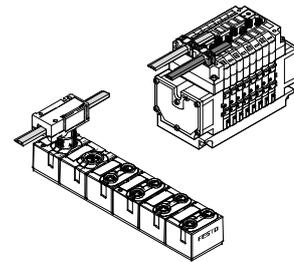
Si un módulo de entradas se encuentra al final de un ramal, el cable plano puede enlazarse también mediante un racor debidamente aislado.
