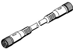
Los cables redondos tienen cuatro hilos y tienen polaridad inconfundible. Las conexiones estandarizadas sustituyen el cable amarillo/negro AS-Interface por un cable único.
