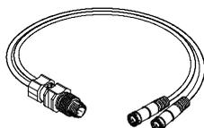
Los cables DUO transmiten a través de 4 contactos las dos señales provenientes de los detectores (cable de 2x 3 contactos). Este cable se conecta a un conector de 4 contactos de un terminal de válvulas, de ASI-EVA o de un módulo compacto de E/S.
