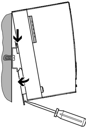
Fijación del gateway mediante perfil DIN. En el dorso de la unidad se encuentran los elementos de fijación correspondientes.
