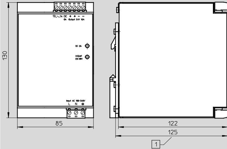
1 Superficie de apoyo, perfil DIN
