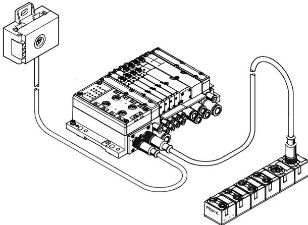
Los terminales de válvulas MPA-S pueden ampliarse con los compactos módulos E/S. Disponibles:
