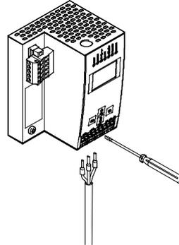
La conexión de la red AS-Interface y la alimentación de tensión para el gateway y el AS-Interface se establece mediante regleta de bornes.
