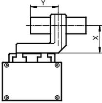
Aus den nachfolgenden Diagrammen können die Greifkräfte in Abhängigkeit von einem exzentrischen Kraftangriff und dem maximal zulässigen außermittigen Kraftangriffspunkt ermittelt werden.
