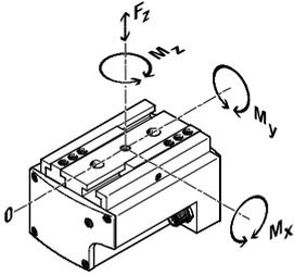
Die angegebenen zulässigen Kräfte und Momente beziehen sich auf einen Greifbacken. Sie beinhalten den Hebelarm, zusätzliche Gewichtskräfte durch das Werkstück bzw. durch externe Greiffinger und auftretende
