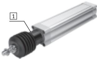
Der Faltenbalgbausatz ist ein leakage-freies System. Um das Ansaugen von unerwünschten Medien zu vermeiden, ist die Zu- bzw. Abluft des Bausatzes über eine Druckausgleichsöffnung im Anbindungsteil **1** gefasst. Der Bausatz schützt die Kolben-
