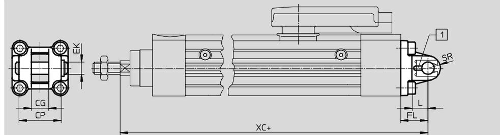
1 Der Achsbolzen ist mittels Spannstift gegen Verdrehung gesichert
