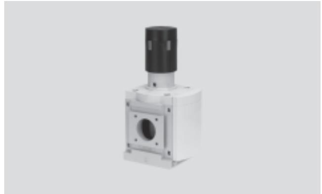
Este regulador mantiene constante la presión de salida p2 independientemente de las oscilaciones de la presión y del consumo de aire. Dentro del margen de regulación es posible regular la presión de salida p2 manualmente con el botón giratorio
