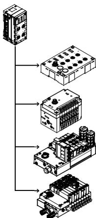
La conexión eléctrica CPX-CTEL-Master establece una conexión con los módulos con interfaz I-Port de la gama CTEL/CTEU. Los datos E/S de las unidades conectadas se transmiten a los nodos de bus CPX y, por lo tanto, a la unidad de control superior a través del bus de campo.
