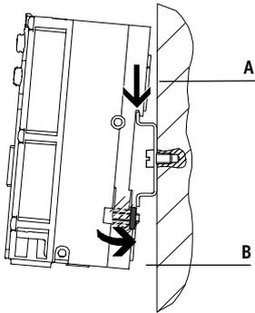
Perfil DIN en la parte posterior de los módulos CPX. El terminal CPX puede montarse fijamente al perfil DIN. El terminal CPX se cuelga en el perfil DIN (ver flecha A). A continuación se gira el terminal y se
