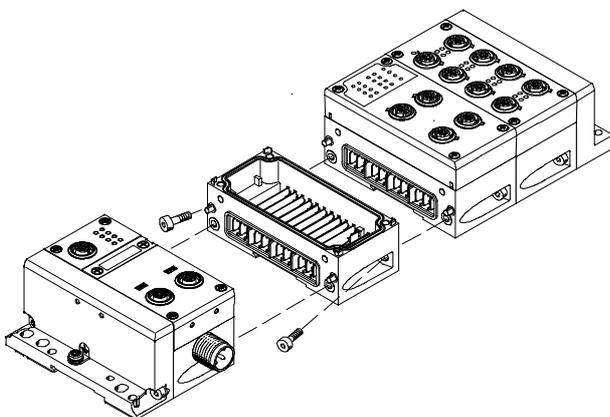
Los módulos CPX se unen entre sí mecánicamente mediante tornillos inclinados. De esta manera, el terminal CPX puede ampliarse en cualquier momento.
