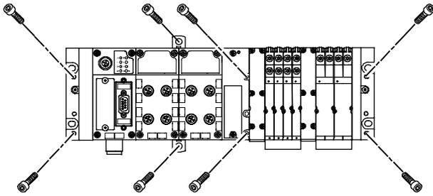
Las placas finales del terminal CPX, del terminal de válvulas y de la interfase neumática están provistas de taladros para el montaje en la pared. Si los terminales de válvulas son más largos, puede recurrirse a los elementos de fijación adicionales para el terminal CPX. Existen diversos tipos de elementos de fijación, según la ejecución del terminal CPX (ejecución metálica o de material sintético)
