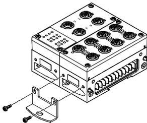
Tratándose de terminales de válvulas más largos, puede recurrirse a escuadras de fijación para el terminal CPX que se atornillan a los bloques de distribución.
