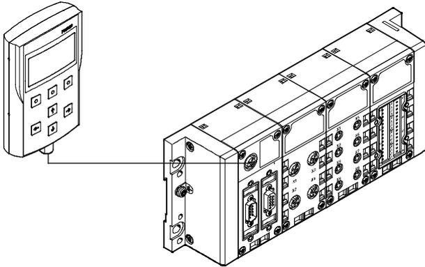
El terminal de mano se conecta al terminal CPX mediante un cable preconfeccionado.
