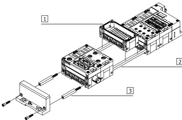
Los módulos CPX se unen entre sí mecánicamente mediante tirantes **2** especiales. Toda la unidad de montaje utilizando únicamente dos tornillos en las placas finales. El tirante soporta una gran carga mecánica, con lo que viene a ser una especie de “columna vertebral mecánica” del terminal CPX.
