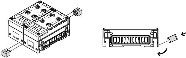
Tratándose de terminales de válvulas más largos, puede recurrirse a elementos de fijación adicionales para el terminal CPX, colocándolos entre dos módulos.
